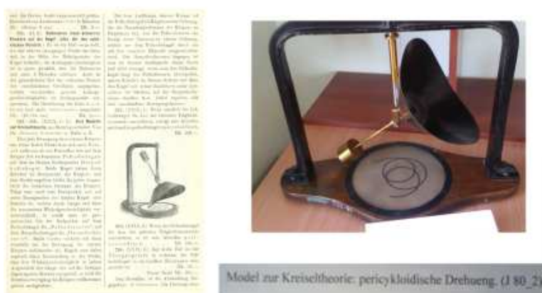
Рис. 4. Модель 2 серии 29 каталога Шиллинга из коллекции Санкт-Петербургского университета («Перициклоидное вращение свободного твердого тела»). Слева страница каталога Шиллинга с рисунком модели, справа сама модель
